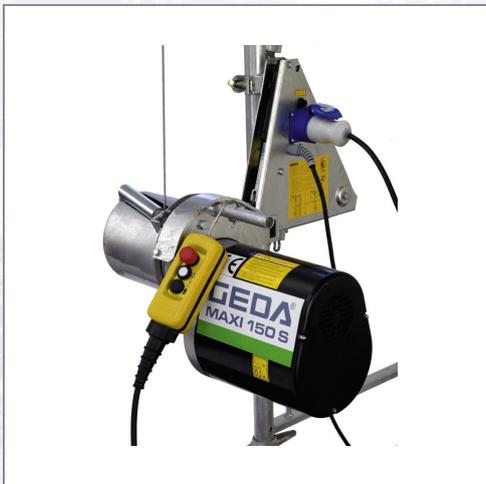
Gerüst-Seilaufzug ohne Schwenkarm mit einer Tragkraft von 150 kg. Steuerung mit Not-Aus 10 m, steckbar. Komplett mit Zugseil, Drallfänger und Haken. - 2 Hubgeschwindigkeiten 15 bzw. 45 m/min, - Motor 0,45 / 1,35 kW / 230 V / 50 Hz.
