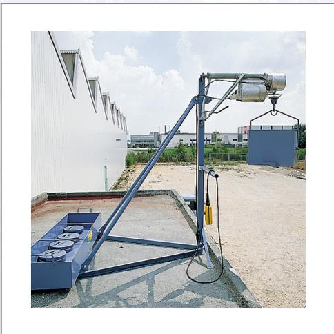
Passend für GEDA Star 200 Standard und GEDA Star 250 Comfort. Freistehender Dreibock mit Ballastbehälter für Flachdach und offene Etagen.
