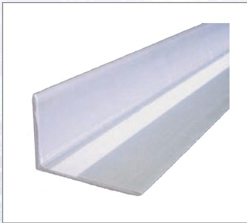
Der feuchtigkeitsbeständige Estrich-Abstellwinkel, ein Pappe-Folien-Laminat, schließt eine Lücke in Bodenkonstruktionen. Speziell im Estrich- und Fußbodenbau sind seine Einsatzbereiche vielfältig: - im Türbereich, - über Heizrohren zur Dehnfugenausbildung, - zur Längsabschalung von Treppenpodesten und Balkonen. Bei einer notwendigen Schall-Längsleitungs-Unterbrechung wird der Winkel mit handelsüblichen Schwellenklebern oder mit selbstklebenden Randstreifen abgeklebt.
