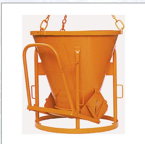
Äpfel und Öfen - fibrä Betonsilo mit konischer Form und geradem Auslauf. Schwere, stabile Ausführung mit Handhebelbetätigung des Patentverschlusses. Standardmäßig mit angeschweißter Kette, optional mit Haken oder Bügel. Lieferbar von 150 l bis 1000 l.
