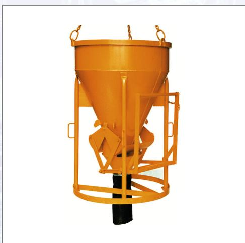
Äpfel und Öfen - fibră Betonsilo mit zylindrisch-konischer Form und geradem Schlauchanschlussauslauf. Extra schwere stabile Ausführung mit Handhebelbetätigung des Patentverschlusses. Geliefert mit angeschweißter Kette. Auslauf mit d= 200 mm (erhältlich auch mit d= 150 mm oder d= 300 mm). Standard mit 0,6 m PVC-Schlauch d= 200 mm. Lieferbar von 150 l bis 4000 l Inhalt.
