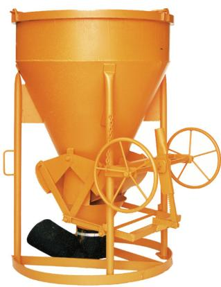
Betonsilo mit zylindrisch-konischer Form und geradem Schlauchanschlussauslauf. Extra schwere stabile Ausführung mit Handradbetätigung des Patentverschlusses. Geliefert mit angeschweißter Kette. Auslauf mit d= 200 mm (erhältlich auch mit d= 150 mm oder d= 300 mm). Standard mit 0,6 m PVC-Schlauch d= 200 mm. Lieferbar von 150 l bis 4000 l Inhalt.
