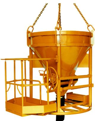
Zylindrisch-konisch mit geradem Schlauchanschluss-Auslauf und Handradbetätigung. Seitlich angebauter Personenaufnahmekorb mit Gitterrost als Boden. Zugelassen für eine mitfahrende Person. Standard mit 0,60 m PVC-Schlauch d= 200 mm. Lieferbar von 500 l bis 1500 l Inhalt.
