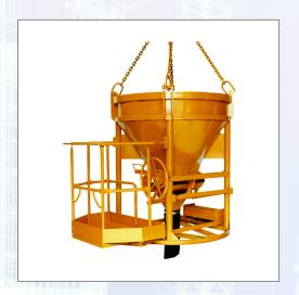
Zylindrisch-konisch mit geradem Schlauchanschluss-Auslauf und Handradbetätigung. Seitlich angebauter Personenaufnahmekorb mit Gitterrost als Boden. Zugelassen für eine mitfahrende Person. Standard mit 0,60 m PVC-Schlauch d= 200 mm. Lieferbar von 500 l bis 1500 l Inhalt.
