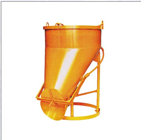
Runde Form mit seitlichem Auslauf. Schwere, stabile Ausführung, Verschluss mit Hebelbetätigung. Standardmäßig mit angeschweißter Kette, optional mit Haken oder Bügel. Lieferbar von 150 l bis 4000 l.
