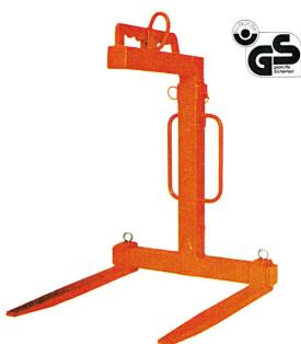
Stufenlos verstellbare Weite durch Hand von 450 - 950 mm. Verstellbare Nutzhöhe durch Absteckbolzen von 1150 - 1750 mm. Gewichtsausgleich erfolgt durch individuelle Positionierung des Trageringes. Lieferbar mit Sicherungskette, mit Schutzkorb oder Ladebox in Normalgröße oder in gewünschter Sondergröße. Tragarmlänge: 1000 mm. Lieferbar für 600 - 3000 kg Traglast.
