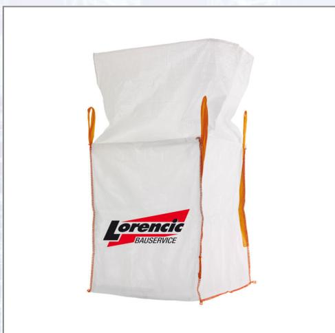
Unbeschichteter, flexibler Einweg-Schüttgutbehälter für die Entsorgung und den Transport von Abfällen, Baustoffen usw. Mit Einfüllschürze zum Zubinden. Technische Daten: - Material: Polypropylen, - Maße: 90x90x110 cm, - Norm: DIN EN ISO 21898, - Nennlast: SWL 1000 kg, - Sicherheitsfaktor: 5:1 (Bruchlast), - geschlossener Boden, - 4 Hebeschlaufen.
