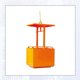
Für höchstens zwei Personen und Werkzeug. Nutzlast 250 kg, Breite 1000 mm, Länge 1410 mm. Umlaufend verkleidet, mit Schutzgeländer auf 1100 mm Höhe und Einstiegstüre auf der Schmalseite. Arbeitskorb an seinem oberen Ende mit einer gefederten Zugöse und 1,40 m langen Seilstrupp, mit 3 Leitrollen an der Breitseite und Schutzdach.
