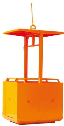
Für höchstens zwei Personen und Werkzeug. Nutzlast 250 kg, Breite 1000 mm, Länge 1410 mm. Umlaufend verkleidet, mit Schutzgeländer auf 1100 mm Höhe und Einstiegstüre auf der Schmalseite. Arbeitskorb an seinem oberen Ende mit einer gefederten Zugöse und 1,40 m langen Seilstrupp, mit 3 Leitrollen an der Breitseite und Schutzdach.
