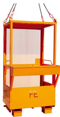
Für höchstens 2 Personen und Werkzeug. Nutzlast 250 kg, Breite 1140 mm, Länge 1225 mm. Geeignet für Gabelstapler- und Kranbetrieb, serienmäßig mit praktischer Werkzeugablage, 4 Kranösen (ohne Kette) und seitlicher Türe für Einstieg. Gebaut nach den arbeitssicherheitstechnischen Bestimmungen der Berufsgenossenschaften.
