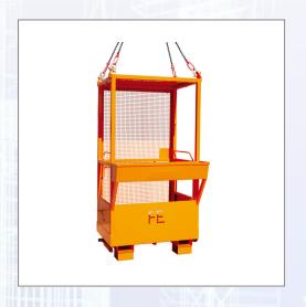
Für höchstens 2 Personen und Werkzeug. Nutzlast 250 kg, Breite 1140 mm, Länge 1225 mm. Geeignet für Gabelstaplerund Kranbetrieb, serienmäßig mit praktischer Werkzeugablage, 4 Kranösen (ohne Kette) und seitlicher Türe für Einstieg. Gebaut nach den arbeitssicherheitstechnischen Bestimmungen der Berufsgenossenschaften.
