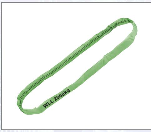
Rundschlinge aus Polyester, Doppelmantel. Hohe Tragfähigkeit bei geringem Eigengewicht. Tragfähigkeit farbcodiert. Sehr flexibles Material, keine Beschädigungen am Hebegut. SF 7:1. Entsprechend EN 1492-2 sowie Maschinen-Richtlinie 2006/42/EG. WLL: direkt: 2000 kg, umgelegt: 4000 kg, geschnürt: 1600 kg, umgelegt  $\beta = 45^\circ$ : 2800 kg, umgelegt  $\beta = 60^\circ$ : 2000 kg.
