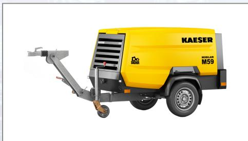
Die kompakten MOBILAIR®-Baukompressoren mit energieeffizientem SIGMA PROFIL und einem sparsamen Dieselmotor erzielen hohe Leistung bei niedrigem Kraftstoffverbrauch. Dank stufenloser Druck-Regelung passt sich die maximale Liefermenge variabel dem eingestellten Maximaldruck optimal an. Die serienmäßige Abgasnachbehandlung ist die Eintrittskarte in Umweltzonen. Die patentierte Anti-Frost-Regelung stimmt die Betriebstemperatur
