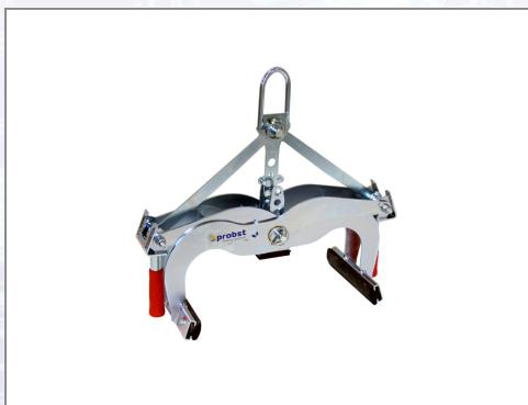
Klein, leicht, handlich und bärenstark! Mechanische Zange zum Greifen von parallelen, nicht konischen Betonelementen zB Rabatten, Stellplatten und Blockstufen. Kann mittels Schlupf oder Kette an ein Trägergerät angehängt werden. Mit Handgriffen ausgestattet, somit auch für manuellen Betrieb mit zwei Personen geeignet. Greifbereich: 0-300 mm, Tragfähigkeit: 550 kg, Eigengewicht: 12 kg.
