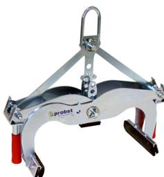
Klein, leicht, handlich und bärenstark! Mechanische Zange zum Greifen von parallelen, nicht konischen Betonelementen zB Rabatten, Stellplatten und Blockstufen. Kann mittels Schlupf oder Kette an ein Trägergerät angehängt werden. Mit Handgriffen ausgestattet, somit auch für manuellen Betrieb mit zwei Personen geeignet. Greifbereich: 0-300 mm, Tragfähigkeit: 550 kg, Eigengewicht: 12 kg.
