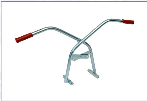
Zum Setzen von Bordsteinen, Randsteinen, Rinnensteinen oder dergleichen. Großer Greifbereich daher auch für Naturbordsteine und Blockstufen geeignet. Durch kurzes Nachfassen bleibt die Richtschnur völlig frei. Es wird empfohlen, die Bordsteinzange paarweise zu verwenden. - Galvanisch verzinkt, - Austauschbare Gummi-Greifelemente. Technische Daten: Greifbereich: 0-400 mm, Eintauchtiefe: 200 mm, Backenlänge: 150 mm, Tragfähigkeit: 150 kg, Gewicht: 4,0 kg.
