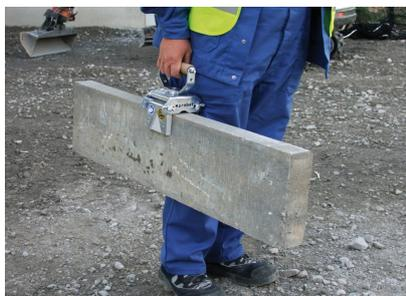
Grundmodul TG-5/12: versieht Rand- und Leistensteine quasi mit einem „Handgriff“. Einstellung der Greifweite in Sekundenschnelle ohne Werkzeug. Mit nur 2,5 Umdrehungen wird die volle Tragfähigkeit von 80 kg erreicht. Kompakte Abmessung, geringes Eigengewicht. Schonendes Greifen durch hochverschleißfeste, austauschbare Gummielemente. Technische Daten: - Greifbereich: 50-120 mm, - Tragfähigkeit: 80 kg, - Gewicht: 3,0 kg.
