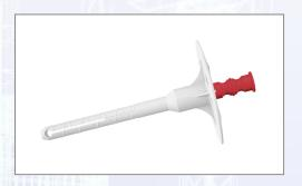
Der wirtschaftliche WDVS-Schlagdübel für alle Standardanwendungen mit Zulassung für die Baustoffklassen A, B und C. Mit dem TERMOFIX CN können WDVS-Fassaden mit druckfesten Dämmplatten aus Polystyrol, Mineralwolle oder Holzweichfasern bis zu einer Stärke von 200 mm auf Voll- und Lochbaustoffen sicher befestigt werden. Der WDVS-Befestiger besteht aus einer einteiligen Hülse mit Tellerelement und einem separat beigelegten Compound-Nagel. Kombinierbar mit
