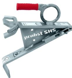
Einfaches und millimetergenaues Versetzen von unhandlichen und schweren Bodenteilen und Schaftkonusen für Straßenabläufe mit dem kompakten Setzhaken SHS. Passend für Bodenteile mit Ablauf und Schaftkonusen nach DIN 4052-3. Schaftteile können bereits auf der Palette auf das Bodenteil aufgesetzt werden und lassen sich so in einem Arbeitsgang verlegen. Handlich und passt noch in jede Werkzeugkiste. Galvanisch verzinkt. Tragfähigkeit: 100 kg, Gewicht: 4 kg.
