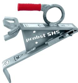
Einfaches und millimetergenaues Versetzen von unhandlichen und schweren Bodenteilen und Schaftkonusen für Straßenabläufe mit dem kompakten Setzhaken SHS. Passend für Bodenteile mit Ablauf und Schaftkonen nach DIN 4052-3. Schaftteile können bereits auf der Palette auf das Bodenteil aufgesetzt werden und lassen sich so in einem Arbeitsgang verlegen. Handlich und passt noch in jede Werkzeugkiste. Galvanisch verzinkt.
