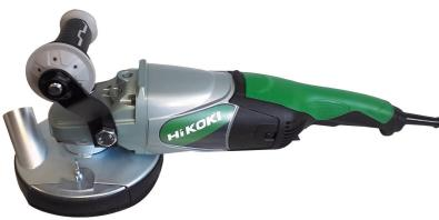
Kompakter, leistungsstarker Betonschleifer mit hochwertiger Motorisolation, UVP (Vibrationsdämpfung) und Spindelarretierung für das Flächenschleifen. Einsatz nur mit leistungsstarkem Rüttelsauger möglich. Technische Daten: - Aufnahmleistung: 2400 W, - Leerlaufdrehzahl: 6600 /min, - Gewicht (nur Maschine): 5,30 kg. Im Lieferumfang enthalten: Betonabsaughaube 180 mm, Schlüssel, Antivibrations-Handgriff.
