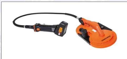
Technische Daten: - Akku-Spannung: 18 V, - Akku-Kapazität: 5,2 Ah, - Werkzeug: 400 U/min, - Gewicht: Handteil ca. 2,1 kg. Im Lieferumfang enthalten: 2 Li-Ion-Akkus (18 V/5,2 Ah), Ladegerät ASC 55, Stützteller mit Klett und Schmirlgel K16 d= 200 mm, in robustem Koffer.
