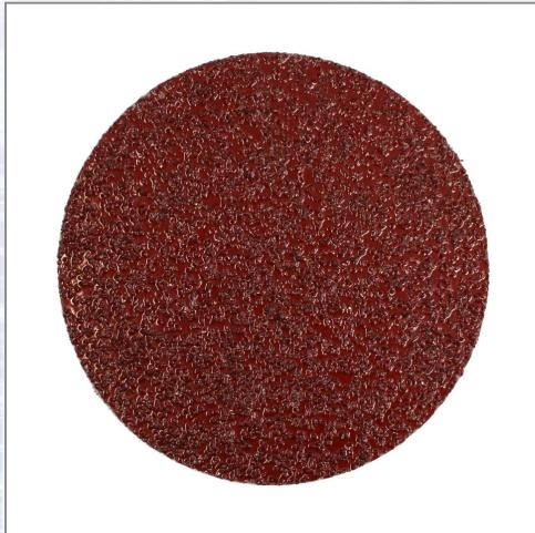
Intensiver Schliff durch stabile Unterlage, hoher Materialabtrag durch schneidfreudiges Schleifkorn, offene Schleifkornstreuung für eine lange Standzeit ohne vorzeitiges Zusetzen. Planschleifen von Plattenstößen und Putzuntergründen, Aufrauen von Polystyroloberflächen, Planschleifen von Polystyrol-Dämmplatten, Steinwoll-Lamellen oder anderen Vollwärmeschutzsystemen.
