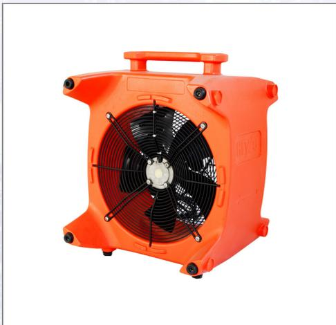
Ideales Arbeitsinstrument für Industrie, Handwerker und Dienstleister. Kompaktventilator mit verschiedenen Aufstellpositionen zur Belüftung von Arbeitsplätzen, Trocknung von Räumen und Wandflächen nach Wasserschäden. Mit eingebautem MID-Energiezähler (geeicht). Technische Daten: - Luftleistung max.: 3687 m<sup>3</sup>/h, - Leistungsaufnahme max.: 0,194 kW, - Pressung max.: 113 Pa, - Abmessungen: (HxBxT) 665 x 520 x 500 mm, - Gewicht: 13,5 kg.
