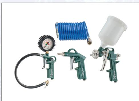
Druckluft-Werkzeugset zu Kompressoren METABO. Set bestehend aus: Blaspistole mit leichtem, robusten Gehäuse aus Aluminiumdruckguss, Druckluft-Farbspritzpistole mit 0,6 l Fließbecher und stufenlos einstellbaren Rund- und Breitstrahl, Reifenfüllmessgerät zum Prüfen und Befüllen von Reifen, PA-Spiralschlauch (4,9 m) mit Schnellkupplung und EURO Stecknippel 1/4".
