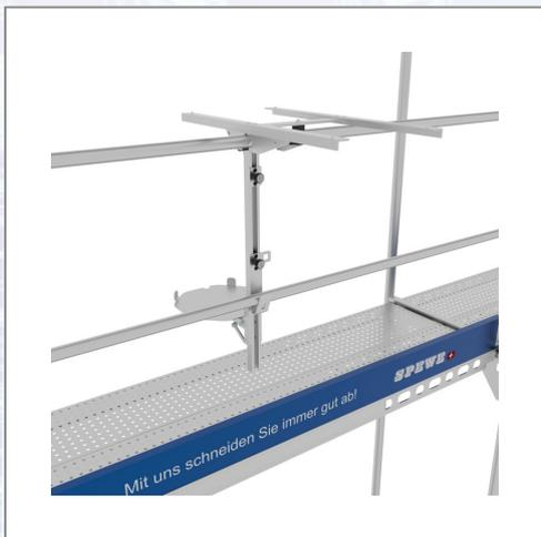
1-teiliges zusammenklappbares Drehgestell mit kombinierter Eimerhalterung für den Einsatz am Gerüstgeländer. Bequem und schnell Kleber auftragen. Rutschfeste Plattenauflage, Auflage 360 ° drehbar, auch für Mineralfaserplatten, körpergerechtes Arbeiten. Technische Daten: - Gewicht: 3,4 kg, - Konstruktion: Aluminium, 1- teilig, zusammenklappbar.
