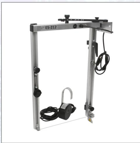
Praktisches Zusatzgerät zum exakten Ausschneiden von Dachsparren oder Eckschnitten im Fensterbank- oder Fenstersturzbereich. Der Eckschneider wird am Spewe 212GSL-30 aufgesetzt und mittels separatem Trafo betrieben. Dachsparrenausschnitte können dank des schwenkbaren Bügels sowohl an der Längs- wie auch an der Breitseite ausgeschnitten werden. Schnitttiefe bis 51 cm, Schnittlänge bis 31 cm.
