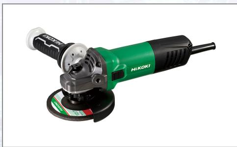
Arbeiten in Ecken und an engen Stellen. Die Schnellverstellung der Schutzhülle ist werkzeuglos möglich. Ist ausgestattet mit einer Spindelarretierung, sicheren Auslaufablage und epoxidharz gepanzerten Wicklung. Technische Daten: - Leerlaufdrehzahl: 12000 /min, - Leistungsaufnahme: 1200 W, - max. Leistungsaufnahme: 1600 W, - Scheibendurchmesser: 125 mm, - Gewicht (nur Maschine): 2,3 kg. Im Lieferumfang enthalten: Anti-Vibrations-Seitenhandgriff, Schlüssel, Transportkoffer.
