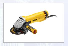
Leistungsstarker Winkelschleifer mit sehr geringem Gehäusedurchmesser und flachem Getriebegehäuse. Nullspannungsschalter verhindert unbeabsichtigtes Wiederanlaufen nach Spannungsausfall. Maximale Maschinenkontrolle durch elektronischen Sanftanlauf. Mit Epoxyd-Harz gepanzerte Wicklung sowie spezielle Kühlluftführung den Motor schützen vor abrasiven Staubpartikeln. Verbesserte Effizienz durch neue Motorarchitektur und Ansaugung der Kühlluft ohne zusätzliches
