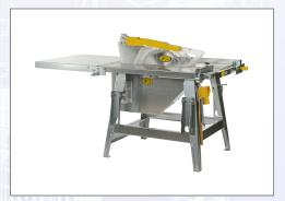
Baukreissäge für die härteren Belastungen am Bau, gemäß EU-19085-10. Serienmäßige Ausstattung: Sicherheitsschutzhaube Tischverlängerung, winkelverstellbare Quer- und Keilschneidlehre, unter dem Tisch angebrachte Führungselemente, abklappbarer Parallelanschlag mit 2 Anlegekanten und millimetergenauer Maßskala, hochwertiges schallgedämpftes Hartmetallsägeblatt, feuerverzinktes und verwindungsfestes Maschinengestell, leistungsstarker Motor mit Magnetbremse,
