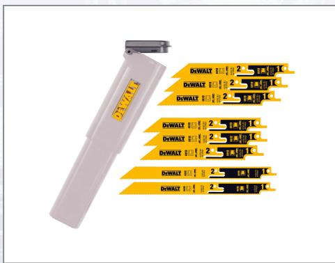
Bi-Metall-Konstruktion, als Kombination aus HCS-Körper und kobaltlegierten HSS-Schneiden. Kobaltlegierte M2-HSS-Schneiden für erhöhte Verschleißfestigkeit. Verstärkte Zahnschulter für verbesserte Stabilität, Universal-Schaft 1/2". Säbelsägeblatt 8 Stück Kobaltstahl - Bi-Metall 6x152x 1,4-1,8 mm und 2x230x 1,4-1,8 mm, abbrechbar. Dickeres Blatt für eine lange Haltbarkeit und erhöhte Lebensdauer bei Schnitten in Metallen.
