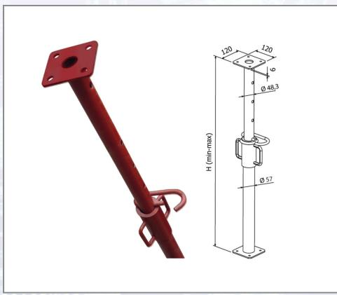
Industriedeckenstützen gemäß EN 1065. Schwere Ausführung für den harten Baustelleneinsatz. Spezielles, leichtgängiges und selbstreinigendes Gewinde. Innenrohr: 48,3 mm, Außenrohr: 57 mm, Vorstecker: 15 mm, Kopf- und Fußplatten: 120x120x6 mm. Ausfallsicherung des Innenrohres, Handquetschsicherung, spezielles, leichtgängiges und selbstreinigendes Gewinde. Deckenstütze Klasse A, lackiert, lackierte Gewindemuffe, Bruchlast: 26,67-10,30 kN, Gewicht: 13,40 kg.
