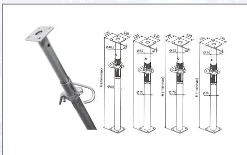
Feuerverzinkte Industriedeckenstützen gemäß EN 1065 für den harten Baustelleneinsatz. Feuerverzinktes Außengewinde. Innenrohr: je nach Größe 57 bis 76 mm, Außenrohr: je nach Größe 70 bis 89 mm, Kopf- und Fußplatten: 120x120x6 mm. Deckenstütze Klasse D, feuerverzinkt, Außengewinde, Bruchlast: 37,60- 21,80 kN, Gewicht: 22,10 kg.
