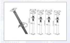
Feuerverzinkte Industriedeckenstützen gemäß EN 1065 für den harten Baustelleneinsatz. Feuerverzinktes Außengewinde. Innenrohr: je nach Größe 57 bis 76 mm, Außenrohr: je nach Größe 70 bis 89 mm, Kopf- und Fußplatten: 120x120x6 mm. Deckenstütze Klasse D, feuerverzinkt, Außengewinde, Bruchlast: 37,60- 21,80 kN, Gewicht: 35 kg.
