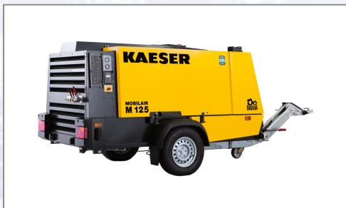
Die kompakten MOBILAIR®-Baukompressoren mit energieeffizientem SIGMA PROFIL und einem sparsamen Dieselmotor erzielen hohe Leistung bei niedrigem Kraftstoffverbrauch. Dank stufenloser Druck-Regelung passt sich die maximale Liefermenge variabel dem eingestellten Maximaldruck optimal an. Die serienmäßige Abgasnachbehandlung ist die Eintrittskarte in Umweltzonen. Die Karosserieteile bieten dauerhaften Korrosionsschutz und
