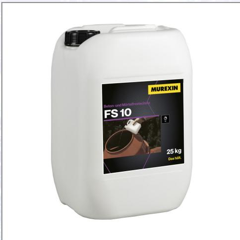
Chloridfreies, flüssiges Frostschutzmittel für Mörtel und Beton. Ermöglicht bei Einhaltung normgerechter Schutzmaßnahmen Mauer- und kleinere Betonierarbeiten bis  $-9\text{ }^{\circ}\text{C}$ . Bewirkt hohe Anfangsfestigkeiten. Im Innen- und Außenbereich für Mauermörtel (Kalkzement- bzw. Zementmörtel) sowie für bewehrten und unbewehrten Beton. Verbrauch: 1 % vom Zementgewicht (ca. 3-4  $\text{kg/m}^3$  Beton).
