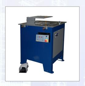
Biegt Rippentorstahl bis 26 mm Durchmesser, Antrieb durch 1,1 kW Elektromotor 400 V. Biegeteller 7 U/min, automatischer Rücklauf des Tellers, Voreinstellung und Auslösung der Biegewinkel durch Kontaktstifte, Bedienung über Fußpedal, Steuerspannung 24 Volt, Notstop-Einrichtung. Mit beweglicher Tafel (9x9), um Biegungen in Sequenz ohne Stiftebewegungen zu machen.
