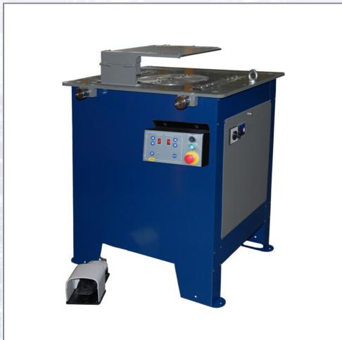
Biegt Rippentorstahl bis 26 mm Durchmesser, Antrieb durch 1,1 kW Elektromotor 400 V. Biegeteller 7 U/min, automatischer Rücklauf des Tellers, Voreinstellung und Auslösung der Biegewinkel durch Kontaktstifte, Bedienung über Fußpedal, Steuerspannung 24 Volt, Notstop-Einrichtung. Mit beweglicher Tafel (9x9), um Biegungen in Sequenz ohne Stiftebewegungen zu
