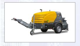
Die M760 STAGE V GREEN EFFICIENCY fördert Estrich bis 190 Meter weit und 135 Meter hoch. Die Bedienung ist dank des Keypads mit farbigen LED-Anzeigen und des modernen Farbdisplays im Steuerschrank denkbar einfach und effizient. Menüs zur Fehlerbehebung und Servicedurchführung erhöhen die Verfügbarkeit. Maximale Power und Effizient - konkret 44,5 kW - bietet der 3-Zylinder DEUTZ-Dieselmotor mit Turboaufladung (Abgasstufe STAGE V). Der integrierte
